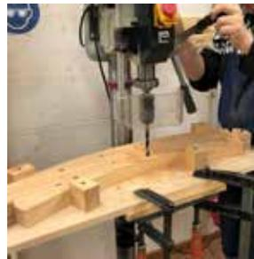
Verbindungslöcher werden gebohrt mit einer Bohrschablone. So muss nicht jedes einzelne Bohrloch ausgemessen/markiert werden.
